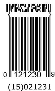
**Slika 5.11.8-5.** GS1 DataBar-14 simbol sa CC-A komponentom sa četiri kolone
